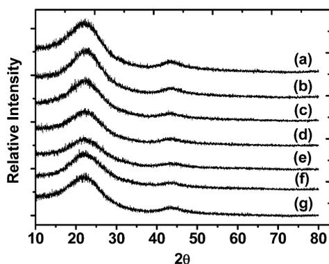
**Fig. 6** XRD diffraction patterns of (a) RF-no IL, (b) RF-10% BMImBF<sub>4</sub>, (c) RF-10%EMImBF<sub>4</sub>, (d) RF-10%OMImBF<sub>4</sub>, (e) RF-10% BMImCl, (f) RF-10%BMImPF<sub>6</sub> and (g) RF-10%BMImN(CN)<sub>2</sub>.
